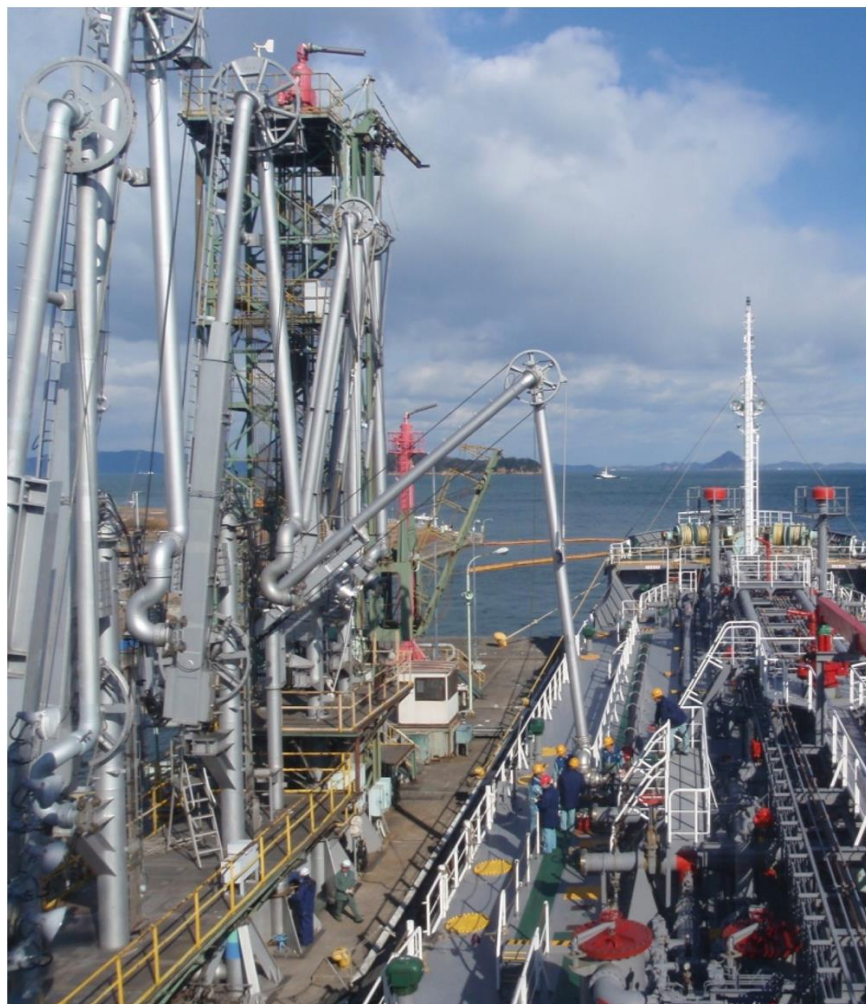
ローディングアームによる荷役 陸上のローディングアームを本船に接続
