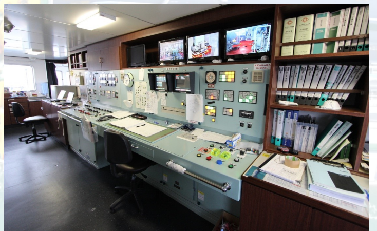
ブリッジ内の機関室遠隔制御システムおよび監視モニター
